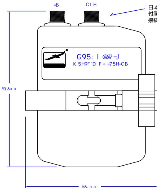
日本で一般的に使われている口径に合わせるため、付属品の「F用ブッシング1/2オス」を使用し、接続してください。
